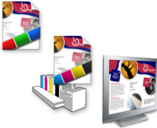
Superior izquierda: Asignamos un perfil de color RGB al documento. Centro y derecha: Al asignar un perfil CMYK específico, podemos obtener una simulación en pantalla de la salida impresa.
